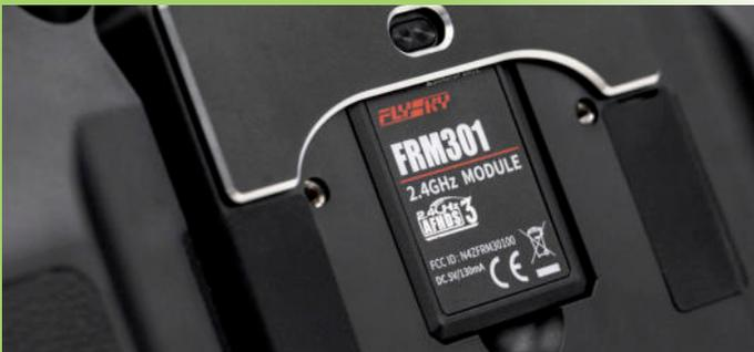
Die PL18EV ist ein 18-Kanal-Anlage für bodengebundene Fahrzeuge, die mit echtem 2,4-GHz-AFHDS3 ausgestattet ist. (Automatic Frequency Hopping Digital System) AFHDS der dritten Generation ermöglicht eine Reichweite am Boden (ohne Hindernisse) von über 300m (in Verbindung mit Empfänger FG12B oder FG8B).
