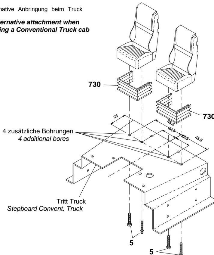
Der Schalensitz kann sowohl in alle Frontlenker-Fahrerhäuser als auch in das Truck-Fahrerhaus von WEDICO eingebaut werden.
